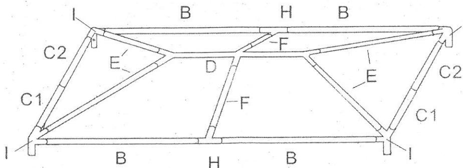
Positionner le pied A dans le tube I puis placer les renforts et visser le tout avec les vis M6x12 (Réf Q)
