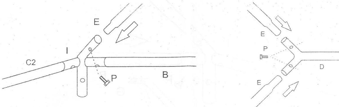
Ensuite, insérer les barres F dans les embouts des pièces H et D
