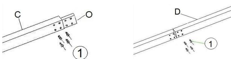
Insérer une partie de la pièce Q dans la barre R, positionner la barre C de façon à pouvoir visser légèrement les 4 vis M8x32mm (Réf 2) pour maintenir l'ensemble.
